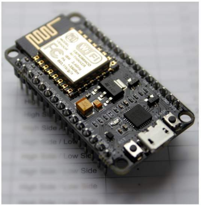
รูปที่ 1 รูป single board nodeMCU (ขอขอบคุณภาพประกอบจากเว็บ URL: http://www.lazada.co.th/nodemcu-4m-bytes-lua-wifi-internet-of-things-developmentboard-based-esp8266-2-14230252.html?ff=1 )
